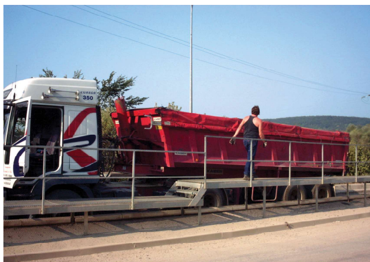
↑ FIGURE 3 Passerelle de bâchage/débâchage
